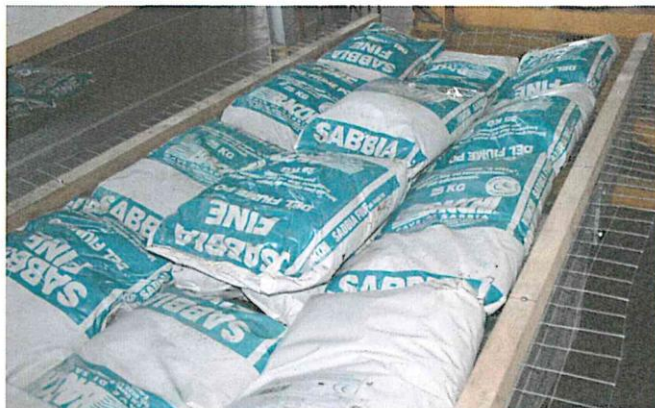
Fig. 7 – Assetto sperimentale B: campione di rete “First” sostenente al carico pari a 1,55 kN/m 2
