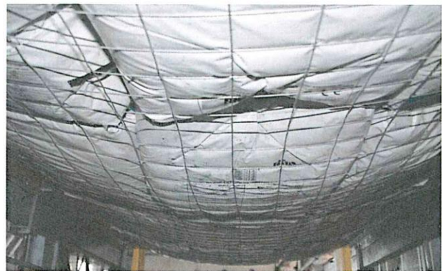
Fig. 11 – Vista intradosso campione B che ha sostenuto carico applicato pari a 3.10 kN/m 2
