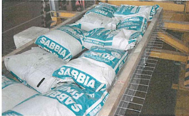
Fig. 6 – Assetto sperimentale A: campione di rete “First” sostenente il carico pari a 1,55 kN/m 2
