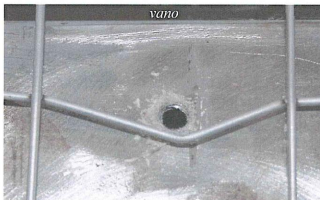
Fig. 14 – Campione A: dettaglio deformazione maglia della rete in prossimità punto di fissaggio centrale di sinistra
