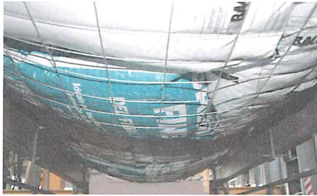
Fig. 9 – Vista intradosso campione A che ha sostenuto carico applicato pari a 3.10 kN/m 2
