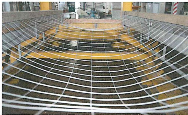
Fig. 10 – Vista campione A rimasto deformato dopo l'eliminazione del carico
