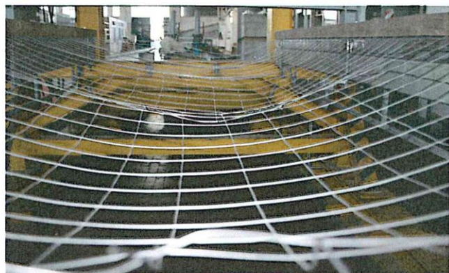
Fig. 12 – Vista campione B rimasto deformato dopo l'eliminazione del carico
