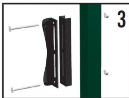
3 • Installare la controserratura ed il battente secondo la direzione di apertura
