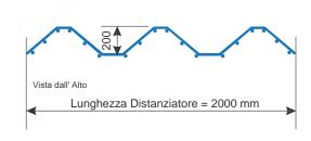
I distanziatori a serpentina hanno la caratteristica principale di essere posati velocemente e di rimanere in posizione verticale grazie al loro particolare disegno. Garantiscono l'integrità della cassaforma e possono quindi essere utilizzati anche in componenti edili che hanno esigenze particolari nelle superfici di calcestruzzo (ad esempio soffitti con calcestruzzo a vista). La produzione copre una gamma di spessori in altezze dai 2 ai 40 cm. Le caratteristiche principali sono le seguenti:
