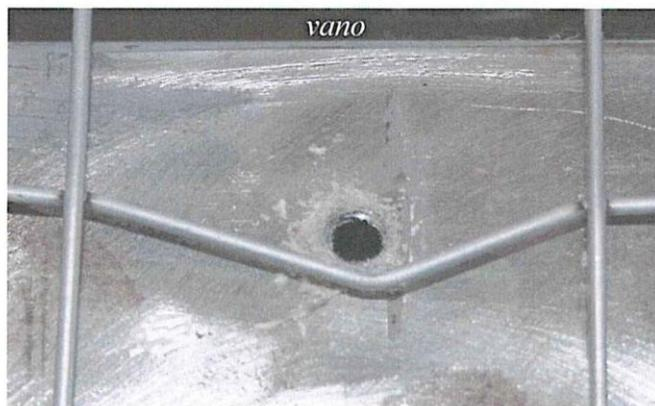
Fig. 14 – Campione A: dettaglio deformazione maglia della rete in prossimità punto di fissaggio centrale di sinistra
