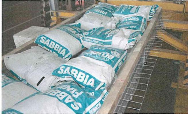
Fig. 6 – Assetto sperimentale A: campione di rete “First” sostenente il carico pari a 1,55 kN/m<sup>2</sup>
