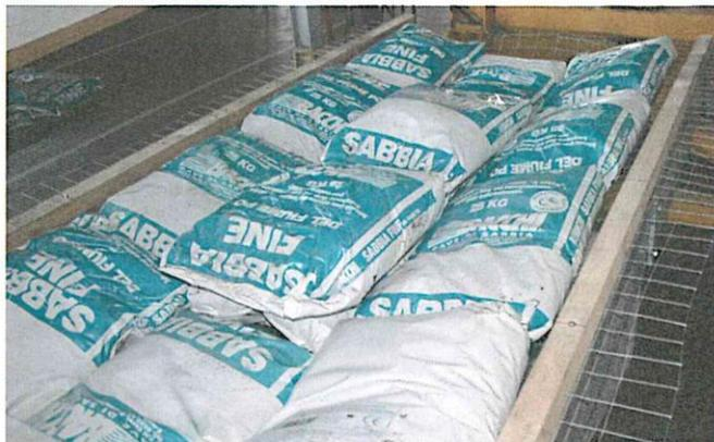
Fig. 7 – Assetto sperimentale B: campione di rete “First” sostenente al carico pari a 1,55 kN/m<sup>2</sup>
