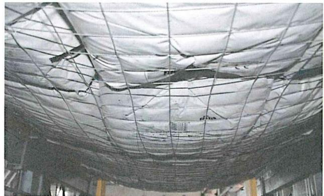
Fig. 11 – Vista intradosso campione B che ha sostenuto carico applicato pari a 3.10 kN/m<sup>2</sup>
