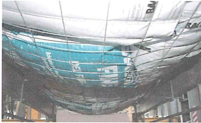
Fig. 9 – Vista intradosso campione A che ha sostenuto carico applicato pari a 3.10 kN/m<sup>2</sup>
