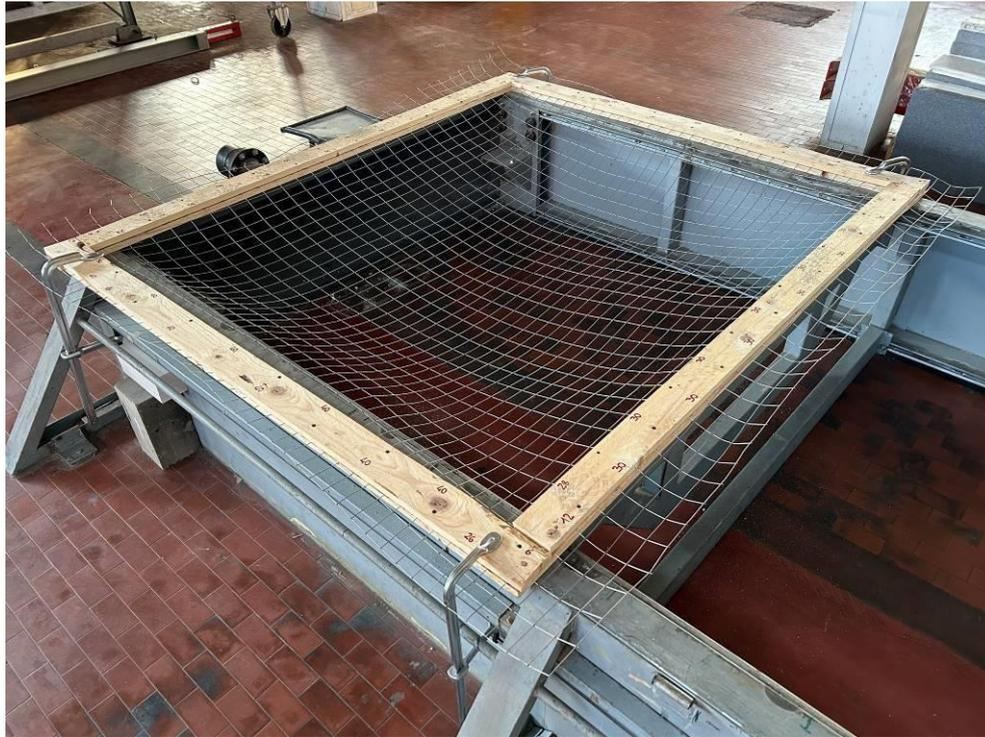
Foto 5: Vista dall'alto del campione di rete "First" rimasto deformato dopo l'eliminazione dei carichi applicati
