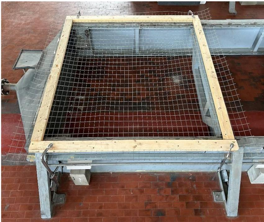
Foto 1: Assetto sperimentale del campione di rete "First" pervenuto e sottoposto a prova
