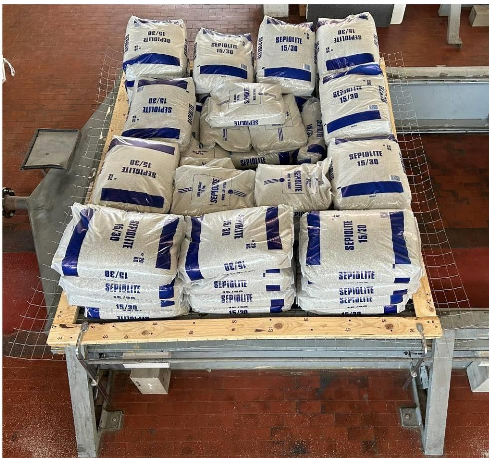
Foto 4: Dettagli relativi alla fase di applicazione del carico limite ultimo pari a  $3 \text{ kN/m}^2$
