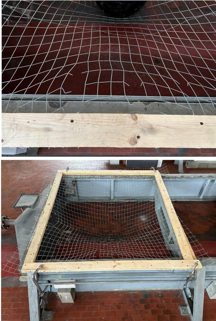
Foto 8 e 9: Dettagli della rottura dei fili in acciaio con scorrimento delle maglie in acciaio dopo urti con altezza di caduta pari a 1800 mm e 2400 mm
