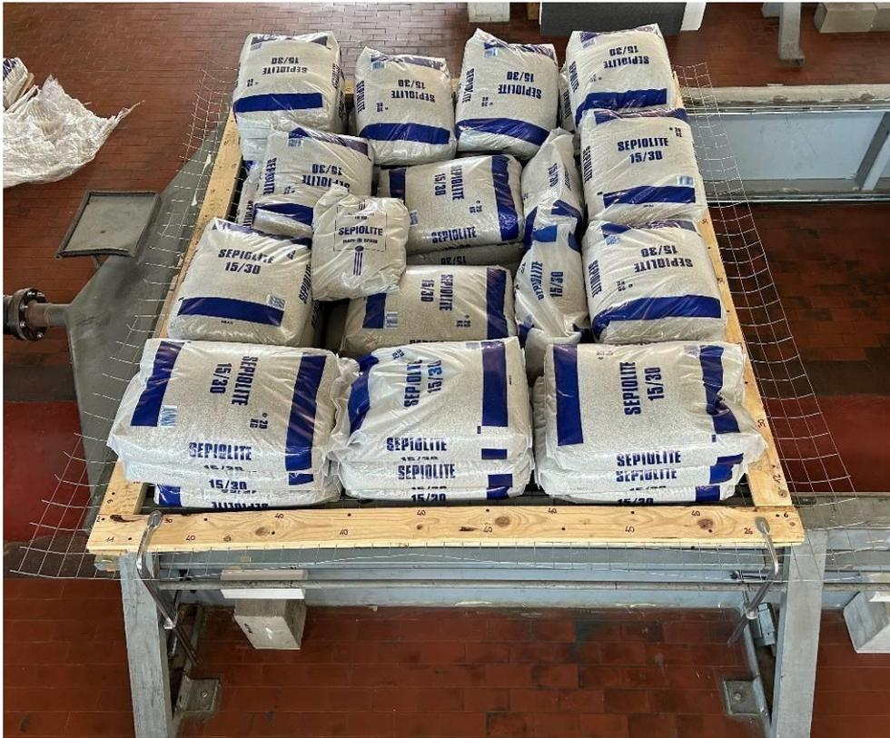
Foto 3: Dettagli relativi alla fase di applicazione del carico di sicurezza pari a  $2,25 \text{ kN/m}^2$
