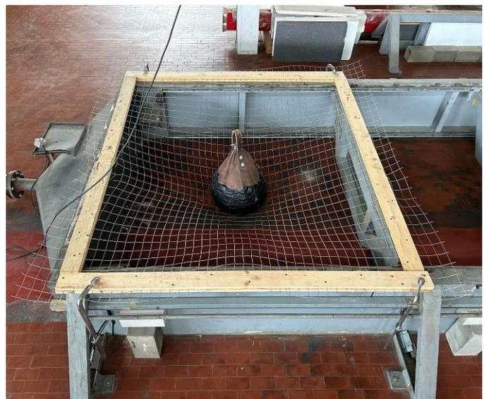
Foto 2 e 3: Dettagli dell'urto da corpo molle con sacco da 50 kg con altezza di caduta pari a 1200 mm - 600 J
