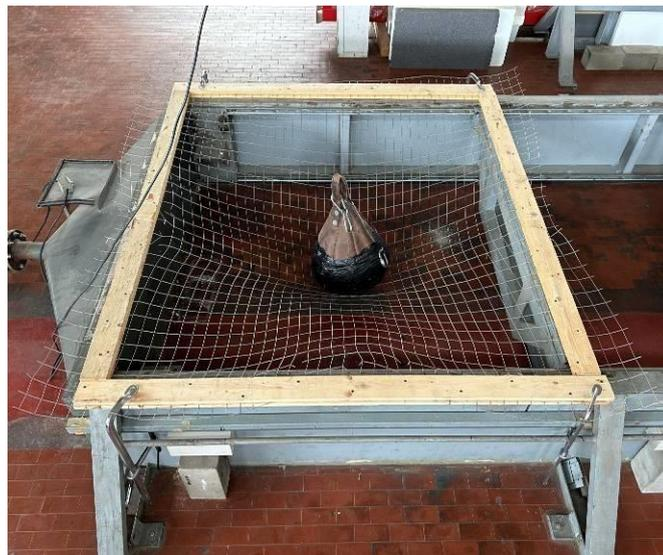
Foto 4 e 5: Dettagli dell'urto da corpo molle con sacco da 50 kg con altezza di caduta pari a 1800 mm - 900 J
