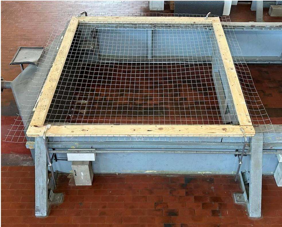
Foto 1: Assetto sperimentale del campione di rete "First" pervenuto e sottoposto a prova al  $T = 0$
