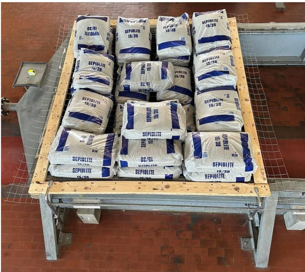
Foto 2: Dettagli relativi alla fase di applicazione del carico di esercizio pari a  $1,5 \text{ kN/m}^2$
